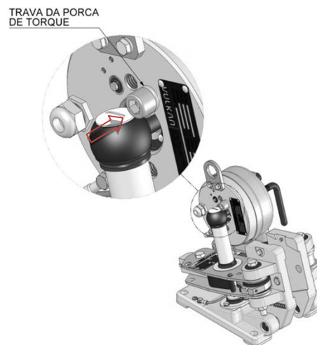
Figura 9-12 – Parafuso e trava da porca de regulagem
