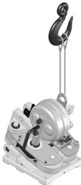
Figura 7-6 – Içamento do freio
